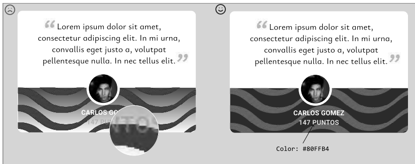
Figura 1.29. La transparencia deja ver la trama. Se soluciona cambiando la luminosidad y la saturación
